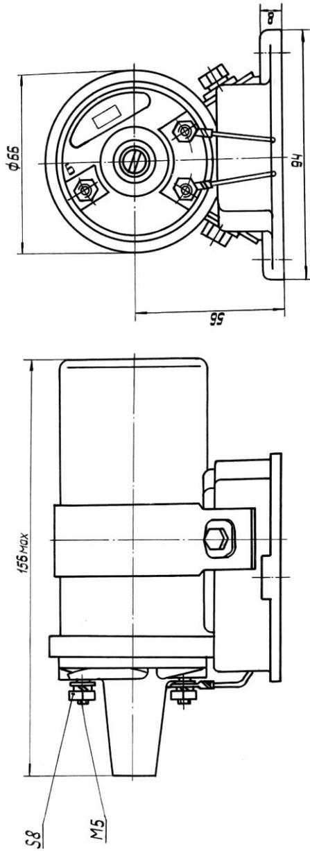
Рисунок 4 – Модуль зажигания
